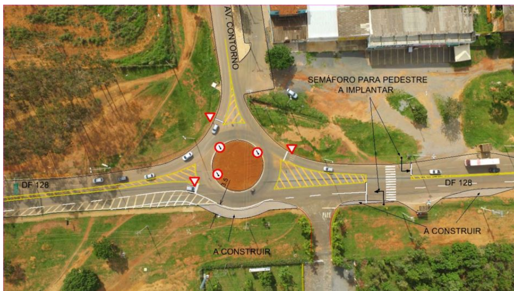
Fig. 05 – croqui esquemático da Travessia e Semáforo na DF-128( medidas 4.2 e 4.3). Fonte: RIST, pag. 51
